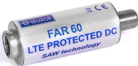
**FAR 60** – это нижнепропускной фильтр LTE, 790МГц, предназначенный для подавления сигналов помех в диапазоне частот свыше 791МГц, среди которых также сигналы LTE 800. Фильтр пропускает полезные сигналы в диапазоне частот 47-790МГц, в котором находятся ТВ сигналы UKF (FM)/VHF/UHF. Фильтр может работать только внутри помещений.
